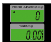
Pantallas de cuarzo con iluminación (backlight)
